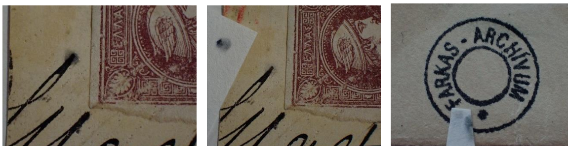
A fekete írótinta és a Farkas bélyegzőfesték oldódása
