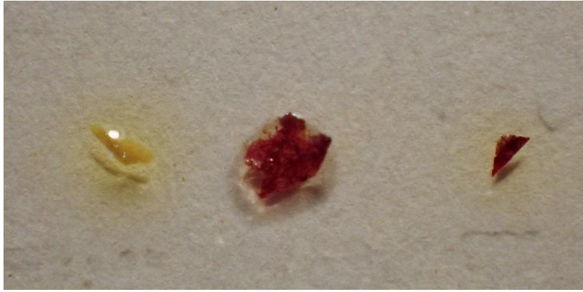
A táviratok papírjából vett minták pozitív lignintesztje (a bal oldali összehasonlító minta negatív)
